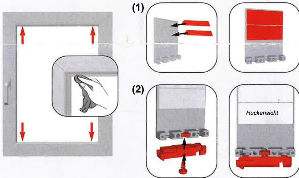
(1) Beiliegende Klebefolie von der Trägerfolie abziehen und auf dem Plissee-Klebeträger anbringen.
