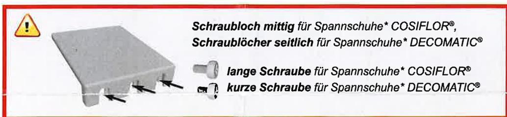
(2) Schraubenmutter je nach Plisseeanlage an entsprechender Position einlegen und das Spannschuh-Unterteil\* montieren (rechts u. links beachten). Bitte die Schraube nicht zu fest anziehen, da der Klebeträger sonst beschädigt werden kann!
